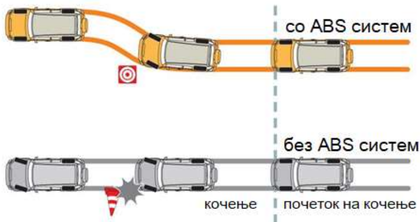
Сл.1.41. Сопирање со ABS систем и без ABS систем
