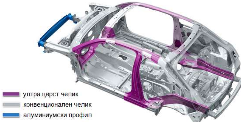
Сл.4.19. Материјали кај самоносечка каросерија во зависност од нивната цврстина
