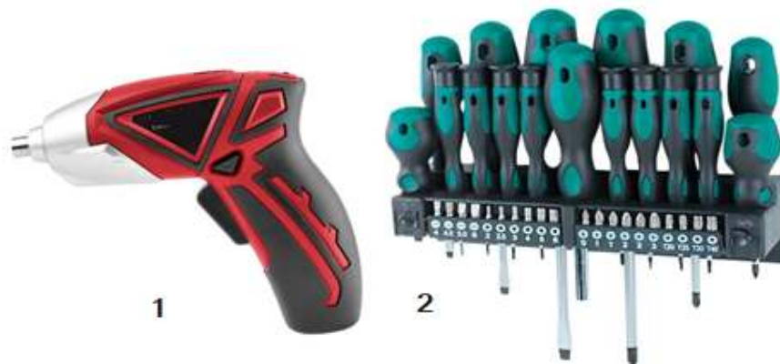
Сл.3.27. Видови одвртувачи (штрафцигери) 1.Електричен одвртувач. 2.Рачени одвртувачи
