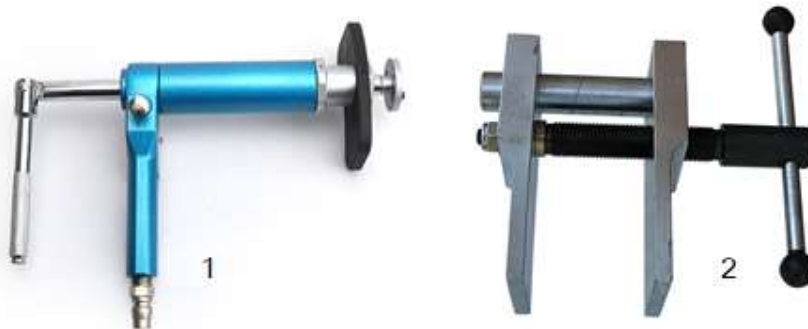
Сл.1.57. Алат за враќање на сопирачките цилиндри 1.Пневматски. 2.Механички.
