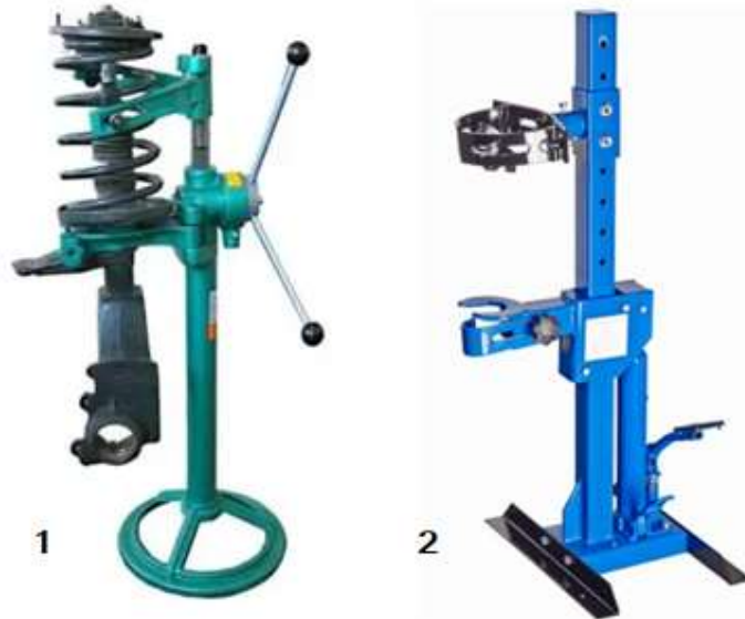
Сл.3.30. Алат за извлекување на пружината од амортизерот 1.Рачен извлекувач. 2.Хидрауличен извлекувач (собирач)
